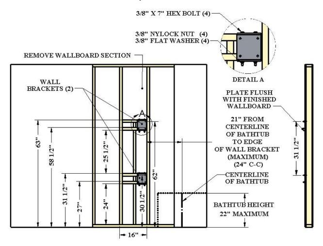
FIGURE 3: TYPICAL WALL-BRACKET INSTALLATION
